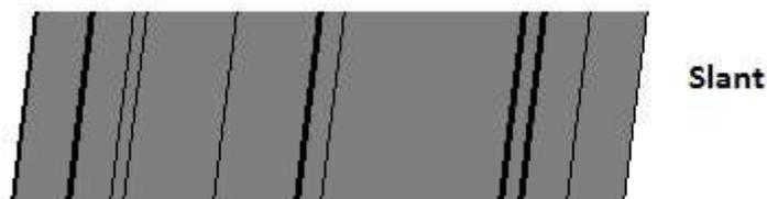
L'image suivante montre le Tilt (l'inclinaison). La dispersion n'est pas horizontale, mais les lignes sont verticales. Cela peut être causé par la rotation de la caméra pour compenser une fente non verticale.
